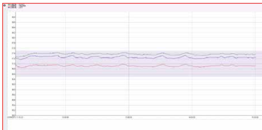
Grafico di stabilità e omogeneità della temperatura, ottenuto con 3 sensori PT 100 equidistanti al centro della camera.
