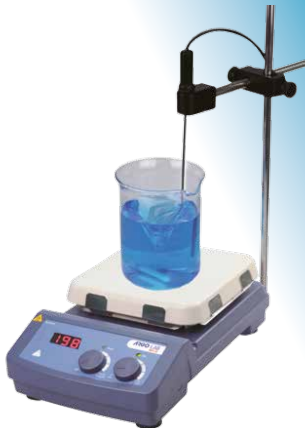
Agitatore M3-D con supporto regolabile e PT 1000
